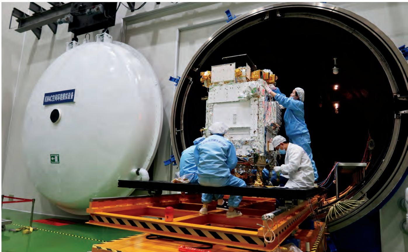
下图：2022年1月9日，创新X卫星进真空罐前进行热控操作。图片提供/中国科学院微小卫星创新研究院
