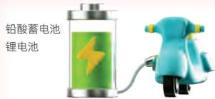
电动车的电池分为**铅酸蓄电池**和**锂电池**两种，前者技术成熟、性能稳定但重量大、体积大，后者能量密度高、充电效率高但成本较高、对温度敏感、更容易出现过热、着火和爆炸风险。不过，不能将安全问题归结为锂电池。实际上，**有问题的不是锂电池，而是劣质的、非正规的锂电池。**
