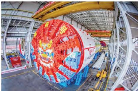
2月26日，一台刀盘涂装“瑞龙”图案的超大直径盾构机“甬舟号”在湖南长沙下线，刀盘开挖直径14.57米，将应用于世界上最长海底高铁隧道——宁波至舟山铁路金塘海底隧道。
