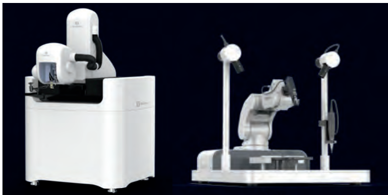
左图：柔性电极植入手术机器人适用于脑机接口的科研和医疗使用。
