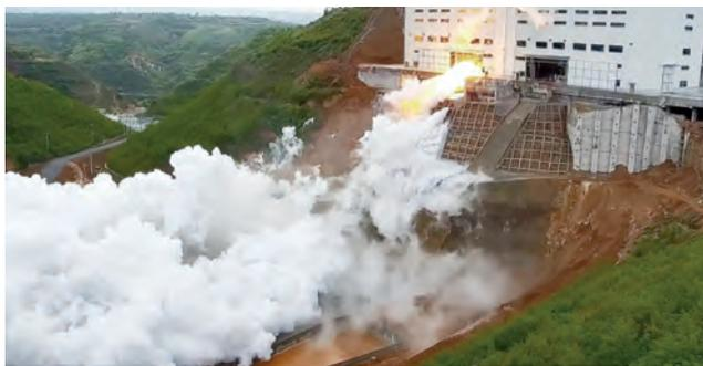
4月24日，“中国宇航新动力铜川试验中心”所属亚洲最大推力700吨液体火箭发动机试验台考台试车圆满成功，可正式投入工程应用。
