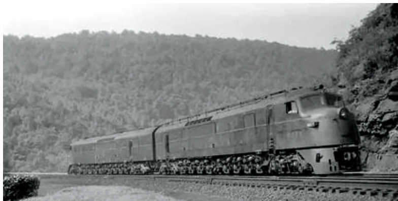
左图：配属宾铁的DR-12-8-1500/2型内燃机车，密集的轮对让这台车有了个响亮的外号：蜈蚣。
