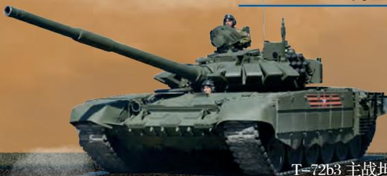
T-72b3 主战坦克是在前型主战坦克基础上的翻新改进型，配备 125 毫米火炮和先进火控系统以及主动防御系统，还可发射炮射导弹，是俄罗斯的中坚装甲力量。
