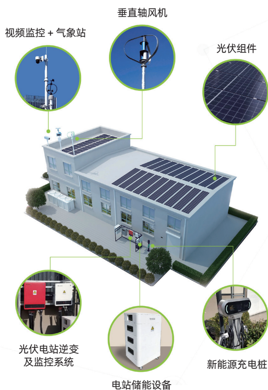
下图：上海探能集团在黎安智谷的风光储充智能微电网项目。
