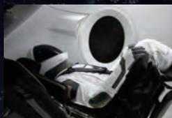
采用7人座和宽货舱设计，内部采用了舒适赛车座椅加触控屏，具有奢华的科技感。在进行轨道飞行时，相比联盟号等一般飞船在操控和舒适性方面有优势。但该飞船没有逃逸安全系统。
