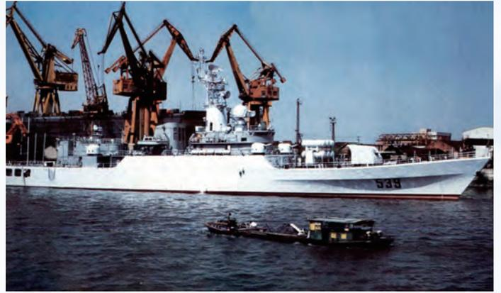
日本《世界舰船》1992年刊登在上海黄浦江畔舾装的053H2G型护卫舰安庆舰(539)，这一镜头拍摄于1991年4月。按照《世界舰船》当时的报道，053H2G型舰正式开启了中国多用途护卫舰发展之路，其设计上有很强的改装适应能力，兼有舰空导弹、舰舰导弹及直升机系统等，具备对海、对空、对潜作战能力，如果突出某一方面作战能力，又可演变成以单一使命为主的护卫舰，同时还能充当中国外贸型护卫舰的母船，根据用户要求组合演变成所需的舰型，可谓一型多用，提高了设计建造的效费比，从而获得建造与使用的军事经济效益。正因为该型舰是如此重要，1989年1月26日，海军特地把安庆舰的建造合同安排在上海丁香花园签署，凸显一个新的时代到来了。
