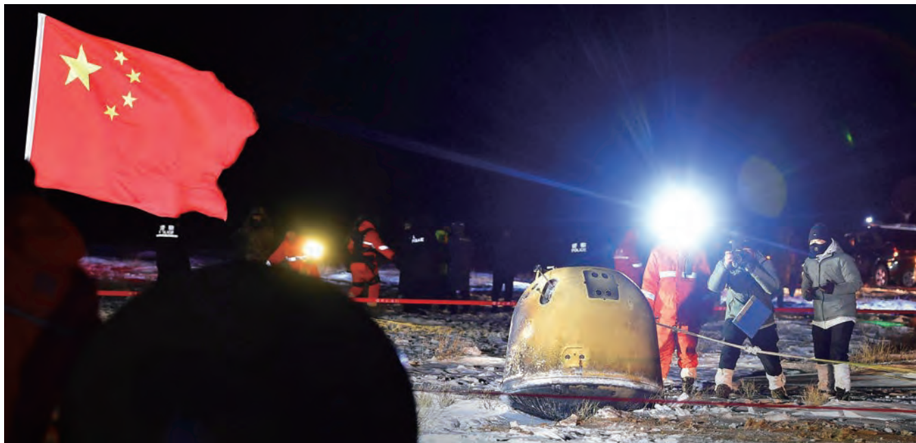
12月17日凌晨，嫦娥五号返回器携带月球样品，采用半弹道跳跃方式再入返回，在内蒙古四子王旗预定区域安全着陆。
