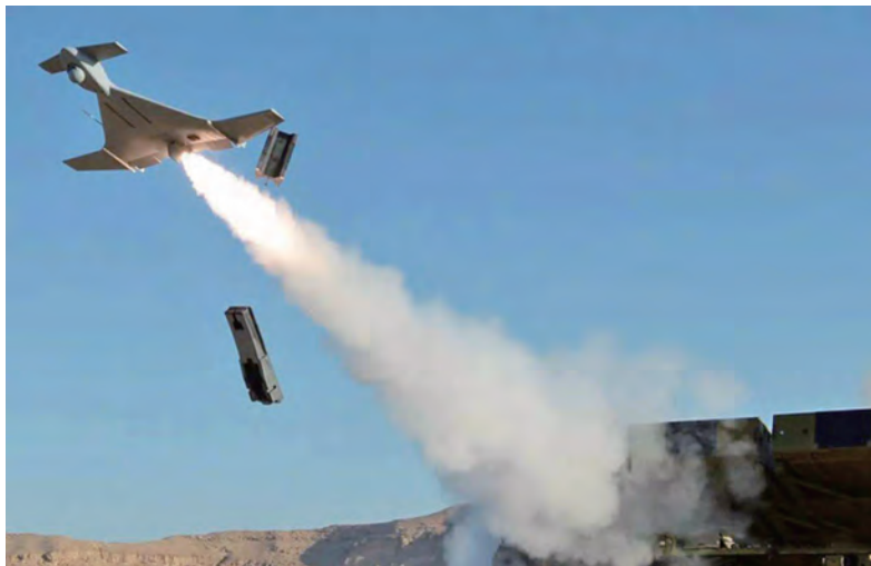
左图:哈比无人机(IAI Harpy)是以色列的以色列航空工业公司(IAI)在20世纪90年代研制的,是可以从卡车上发射的,可对雷达系统进行自主攻击的无人机。
