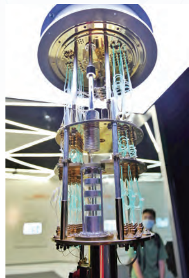
右图：阿里巴巴上海研发中心。图为量子计算机的稀释制冷机控制台。摄影/薛慧卿
