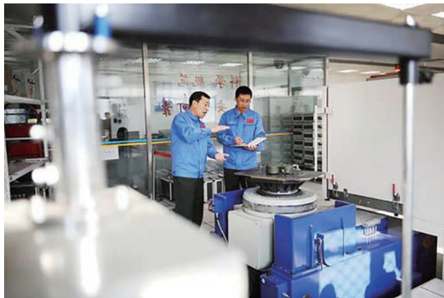
2013年10月21日，技术人员对北斗车载用户终端的天线进行抗振动试验。
