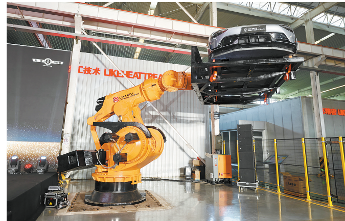
■ CR5000-3700重载工业机器人可举起一台汽车
