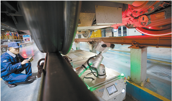
2月10日22:14,检修机器人检查动车组齿轮箱等重要走行部件,地勤机械师朱贵来复核机器人检测出的故障点
