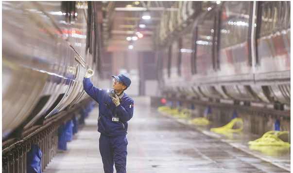
2月10日23:52,地勤机械师刘文弟用“五点敲击法”,确保裙板安装到位。不少负责这一工作的机械师的手都“敲”出了老茧
