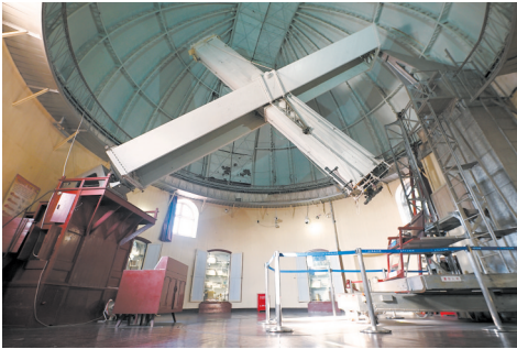
佘山天文台40厘米双筒折射望远镜 汤海明 摄
