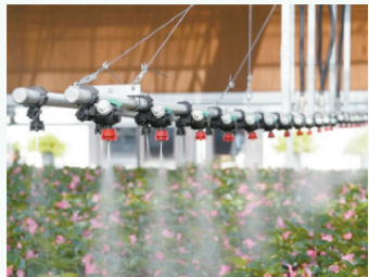
智能肥水系统，肥料精准配比，多余的水还能回收再利用
