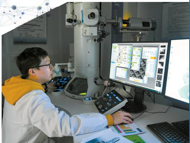
■ 工程师通过透射电子显微镜的电磁透镜调节系统
