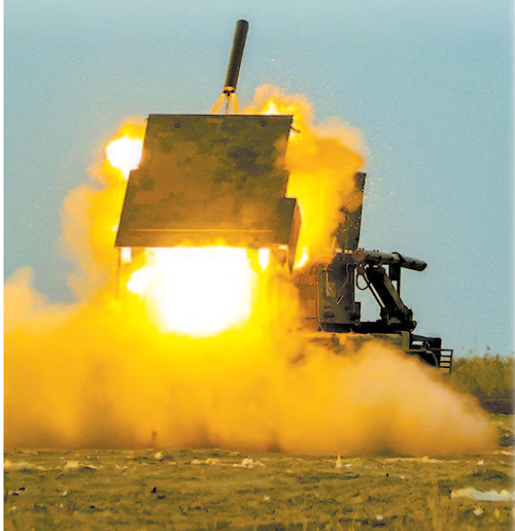
■ 扫雷车发射火箭扫雷具瞬间
