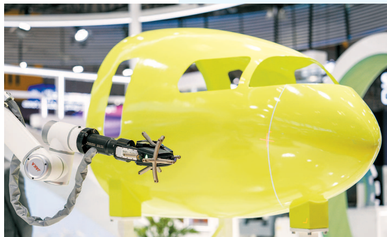
海克斯康带来航空零件检测方案，以自动化、柔性化的方式检测大型航空零件的完整性以及对接装配的精准度
