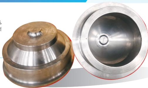
■ 耐热高强钛基复合材料的典型构件
