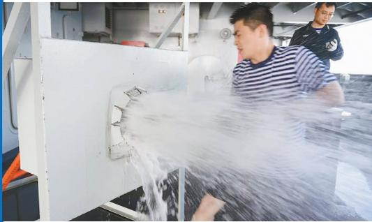
■ 戚继光舰学员使用堵漏器材进行损管训练
