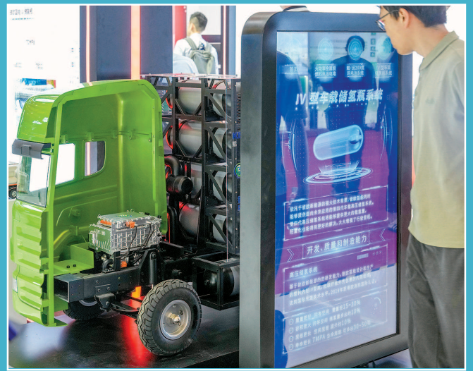
申能展台展示了带有高压储氢系统的氢能源商用车模型 本报记者 陈梦泽 摄
