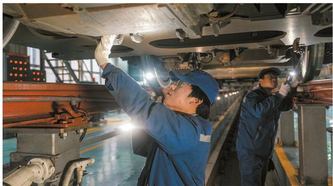
▲ 2月3日,虹桥动车运用所临修三班的地勤机械师正在检查动车车轴处是否结冰
