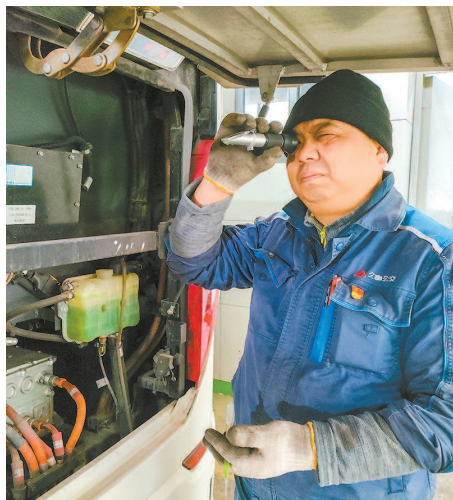
巴士三公司技术人员正在进行公交车防冻液冰点检测 通讯员 黄罗成 本报记者 陈梦泽 摄
