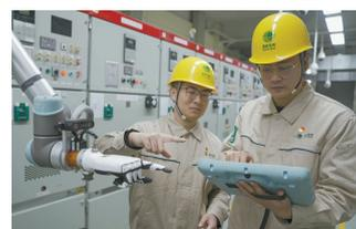
新型仿生机器人“浦睿”按照操作票上的任务设置，流畅、规范地完成了退压板、拉红白带、开合柜门等一系列操作。对于这个即将在110千伏前滩变电站“上岗”的数字化员工，浦东供电公司运检部副主任万轶伦信心十足：“‘浦睿’做到了操作任务的精准执行，可以完成变电站基本操作。”
