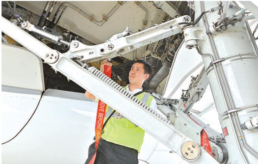
■ 裘磊正在检查飞机起落架插销
