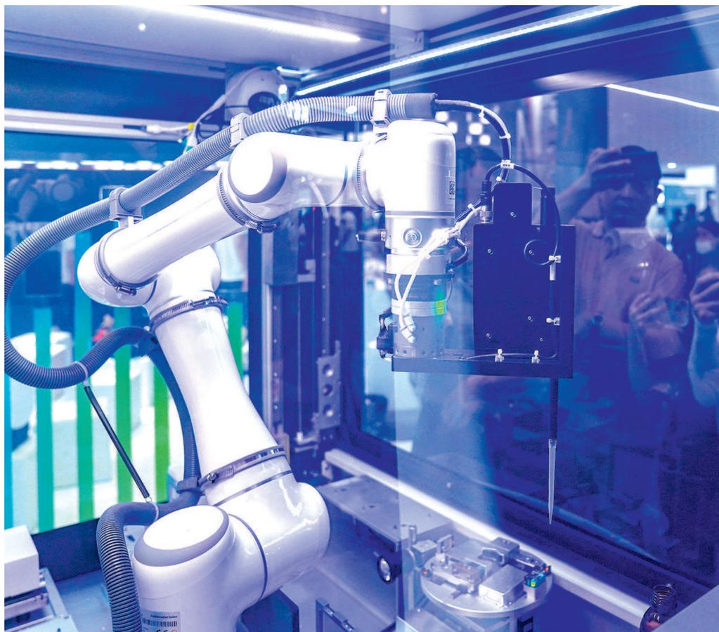
■ 晶泰科技 AI 药物研发自动化机器人可以在现实中合成 AI 设计的具有成药潜力的分子,并作测试
