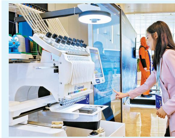
云智能刺绣系统亮相2023中关村论坛。该系统通过智能制版、设备云平台交互、机器视觉、全自动化控制，实现功能强大的个性化刺绣，满足所见即所得的客户定制需求。据悉，该系统三字名字的刺绣需要3000至5000针，大概3分钟即可完成，文字支持10多种语言、100多种字体，可应用于实体店和网店定制化产品，能像照片一样立等可取。
