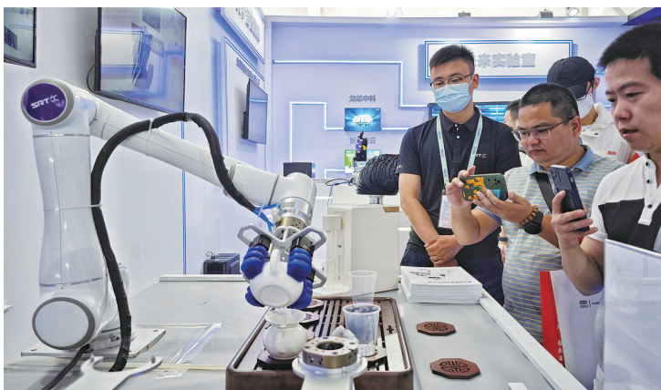
▲ 机器人“茶艺师”的蓝色“夹爪”能模拟煮茶师倒水、泡茶、倒茶等一系列动作 ▲ 单孔腔镜手术机器人系统的镍钛合金蛇形手术臂展示剥鹌鹑蛋的蛋壳
