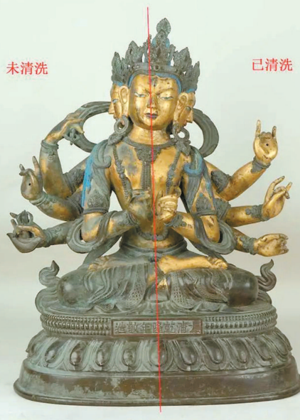
清代积光佛母像激光清洗效果对比
