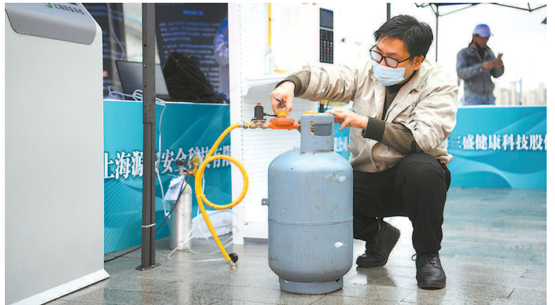
工作人员介绍液化天然气紧急切断阀 本报记者 孙中钦 摄
