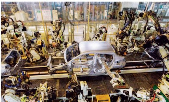
▲高精度焊接机器人使焊装水平行业领先
