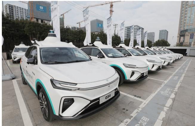
今天上午，自动驾驶网约车“享道 Robotaxi”整装待发，车顶可见装有多重雷达设备
