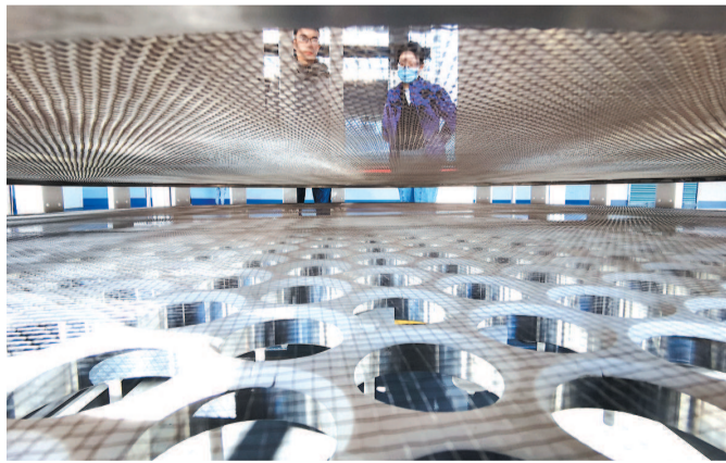
■ 该所实验装置——PandaX-4T探测器原型机 本报记者 孙中钦 摄
