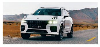
豪华底盘结构,铝制部件占比达 48%, 在极大降低籍下质量的同 时,提升整车操控性能。首次搭载 的全新FYRA四驱系统, 在扭矩容 量、响应速度、轻量化、控制精度等 性能大幅度提升,可实现前后轴 动力扭矩95:5-50:50之间任意调 节。其八大动态驾驶模式,四种智 能联动越野场景,可轻松应对多 种路况,实现更精准、更稳定、更
