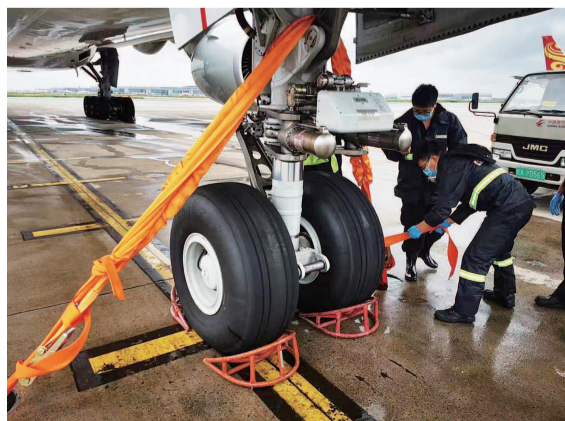
■ 停航后,东航工作人员每拉紧一根系留绳后都会反复检查,确保飞机牢牢固定在机场地面 通讯员 李盛 记者 陈梦泽 摄
