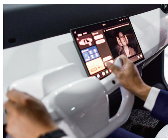
指令输入 华为车机系统通过识别驾驶员唇形便能完成 本报记者 陈梦泽 摄
