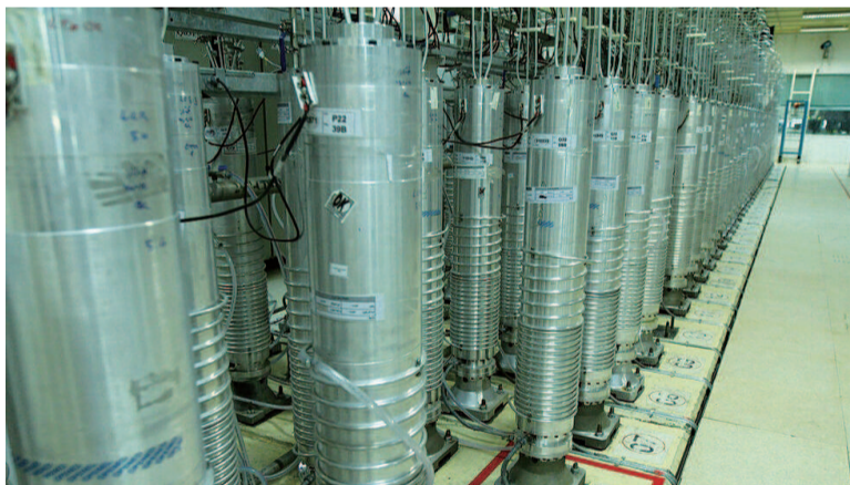
投入使用的纳坦兹核设施的铀浓缩离心机于二〇一九年
