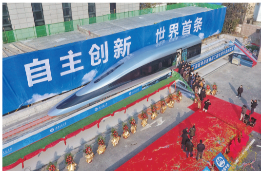
■ 高温超导高速磁浮工程化样车外观及试验线 新华社发
