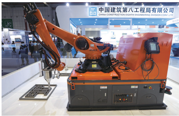
■ 中建八局的3D打印机器人 本报记者 张龙 摄
