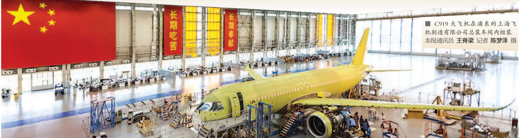
■ C919 大飞机在浦东的上海飞机制造有限公司总装车间内组装
