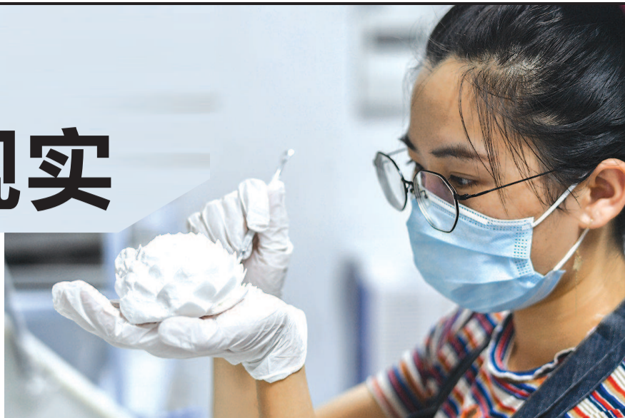
李涛正去除一朵3D打印“荷花”的多余粉末支撑,这是3D打印后处理的重要步骤
