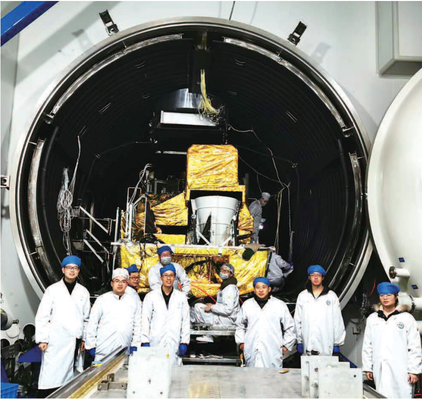
■ 风云四号02星干涉式大气垂直探测仪定标试验 上海技物所 供图
