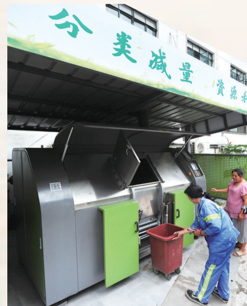
黄浦区外滩街道瑞福小区的湿垃圾分类处理机，可将二百公斤湿垃圾变成浓缩有机肥
