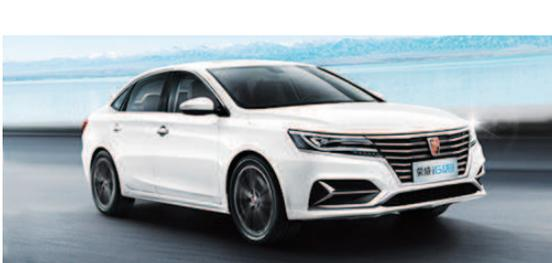
荣威ei6 PLUS是全球首款插电混动互联网轿车,升级采用了电机油冷和Hair-pin绕组技术,1.5T发动机配合电机,爆发出最大综合功率224kW,最大综合扭矩480Nm的动力输出。
