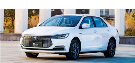
全新秦EV实现电机、电控、变速器的高效集成,NEDC综合工况续航达到421km,充电15分钟行驶100km,除拥有DiLink 2.0智能网联系统、云服务外,还加持了遥控驾驶黑科技。
