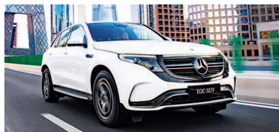
奔驰EQC是梅赛德斯-奔驰是中国市场首款国产豪华纯电动车型。动力来源于前后双感应异步电机,可实现最大功率408马力,峰值扭矩为730牛米,满电NEDC工况里程达到415km。
