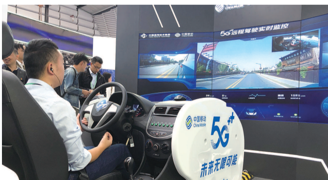
通过远程驾驶系统,驾驶员在室内就可操控户外行驶的车辆 毛丽君 摄
