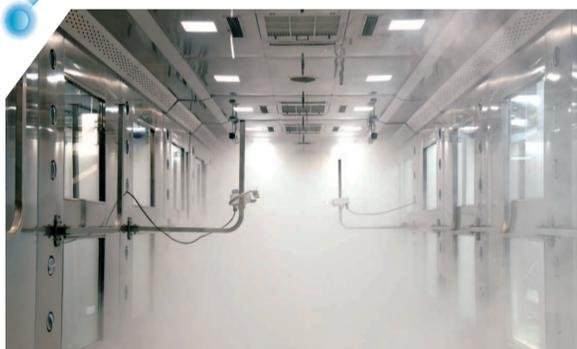
实验方舱内,通过超声波造雾可以在10分钟内将能见度降到10米以内 采访对象供图
